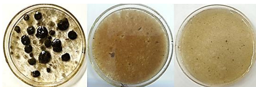
شکل ۹. روند تغییر لجن اولیه و تشکیل گرانول‌ها
