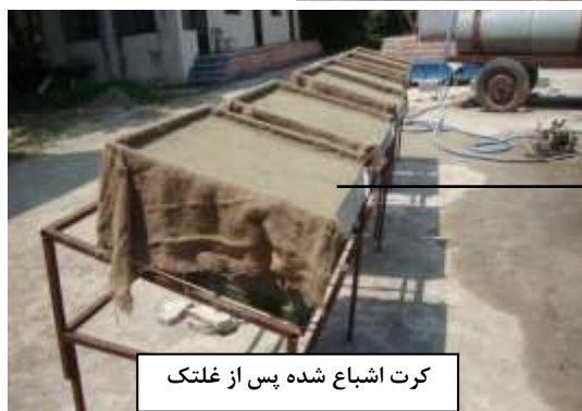
شکل ۲. نمایی از روش آماده‌سازی و کاربرد پلات‌های فرسایشی استفاده‌شده در پژوهش و مراحل اجرای آزمایش
