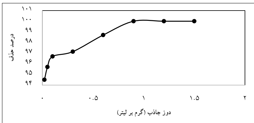
شکل ۴. تأثیر پارامتر دوز جاذب در حذف آرسنیک (زمان ماند ۳ دقیقه، غلظت ۱۲۰ میکروگرم بر لیتر، pH=۷)
